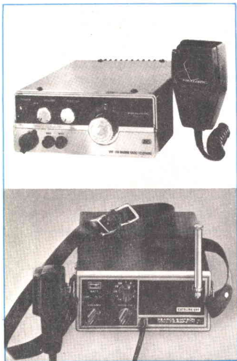
Ricetrasmittitore a dodici canali Modello TRM-12 della Realistic (in alto); ricetrasmittitore munito di batterie Modello Catalina della Pearce-Simpson (in basso).
